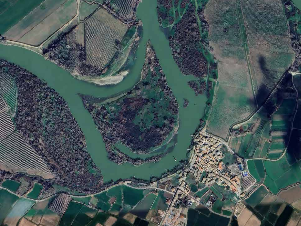
Figura 3. Ebro Resilience: cauce de alivio abierto en Alcalá de Ebro. En mediciones realizadas por Ebronautas en el proyecto de investigación Sedexchare durante una pequeña crecida en marzo de 2024 se constató que dos tercios del caudal circulaban por el cauce de alivio y solo un tercio por el cauce principal que pasa pegado a la localidad. Fuente: Google Earth. © Google, Maxar Technologies. Consulta: marzo de 2024.
